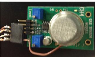
Capteur de gaz multiple Hanwei Electronics CO. MQ-5
