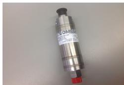
Capteur de pression barométrique Omega PX02K1
