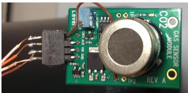
Capteur de CO<sub>2</sub> Hanwei Electronics CO. MG811
